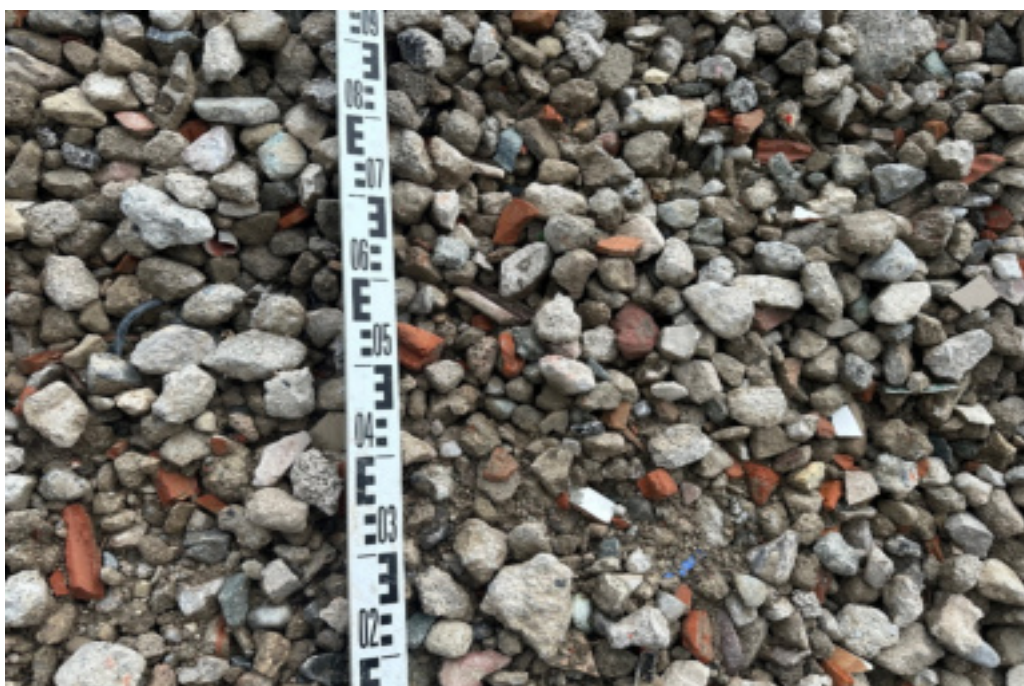
Foto 2: Detailaufnahme der recycelten Gesteinskörnung
